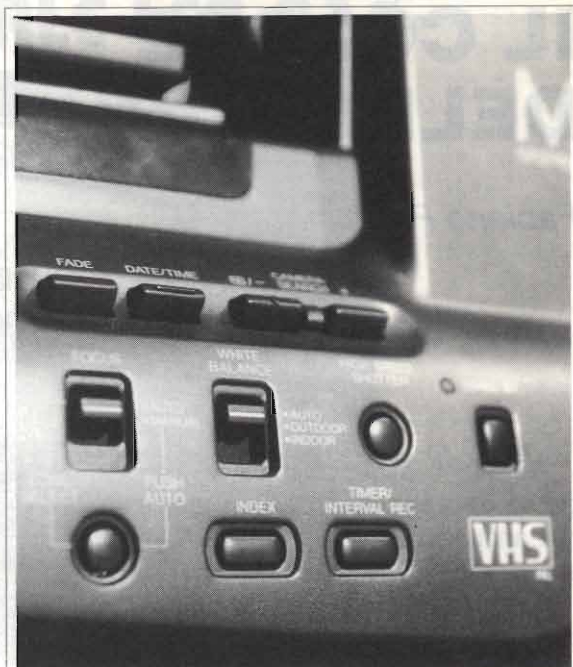
Un moderno Camcorder PANASONIC. Si notino la scomparsa dal controllo manuale dal bilanciamento del bianco.
