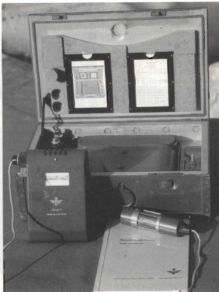
La cassetta del contatore Geiger FH40T con i componenti principali
