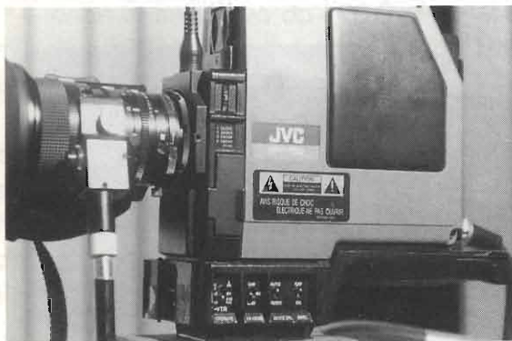
Telecamera professionale JVC-BY110 serie di filtri ottici e possibilità manuale di bilanciamento del bianco.
