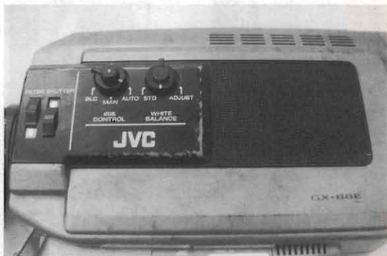
Una vecchia telecamera JVC-88E. Si notino i filtri ottici e la possibilità di bilanciamento manuale del bianco
