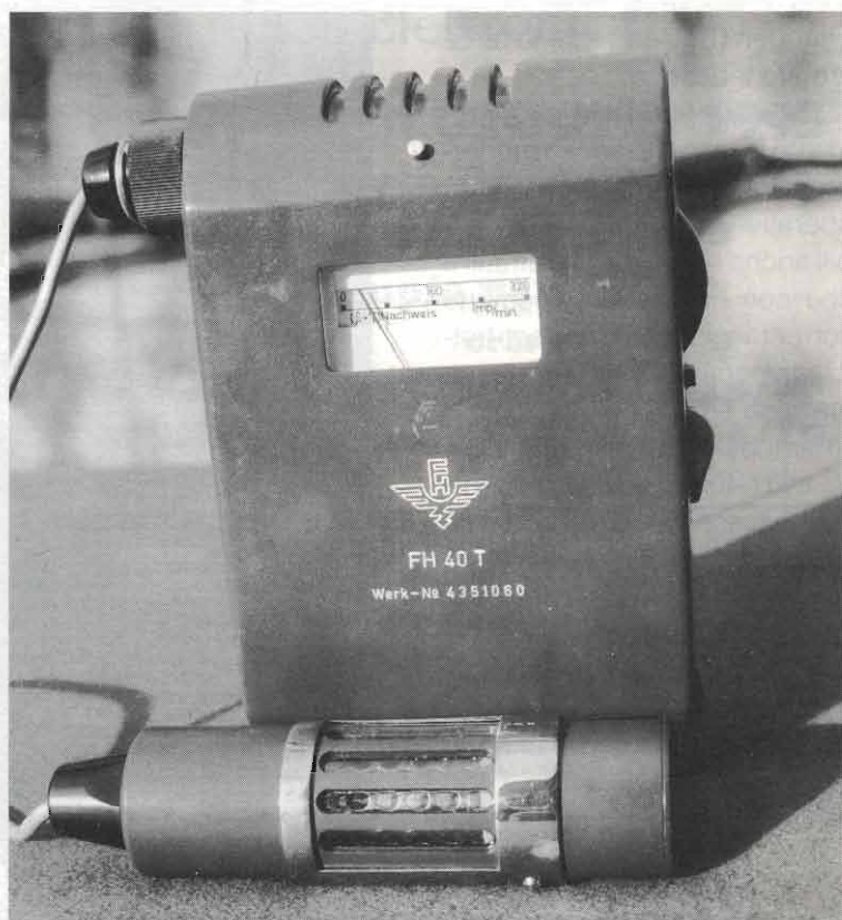
L'FH40T con la sonda esterna. Notare l'indice del microamperometro, che indica un impulso di radiazione in arrivo
